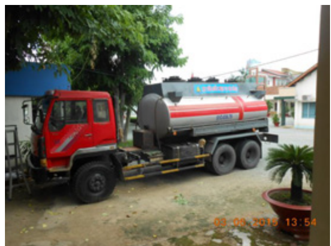
Xe bồn tưới nước chống bụi và cung cấp nước cho khu vực thi công công trình.
